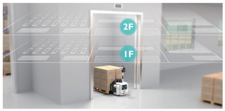
多階層・多エリアの材料搬送に対応するため、制御システムMW-WCSを介してリフトや自動ドアと連動し、フロア切替やリフト・自動ドアへのアクセスなどのエリア搬送を自動で行います。
